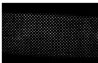
Ici, la BL BAR montée en backlight permet d'examiner en continu la qualité d'un tissu à l'aide d'une caméra linéaire
